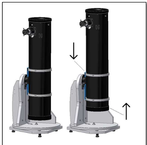
Figura 19. ¡Mueva la cola de milano hacia abajo y el tubo hacia arriba!
